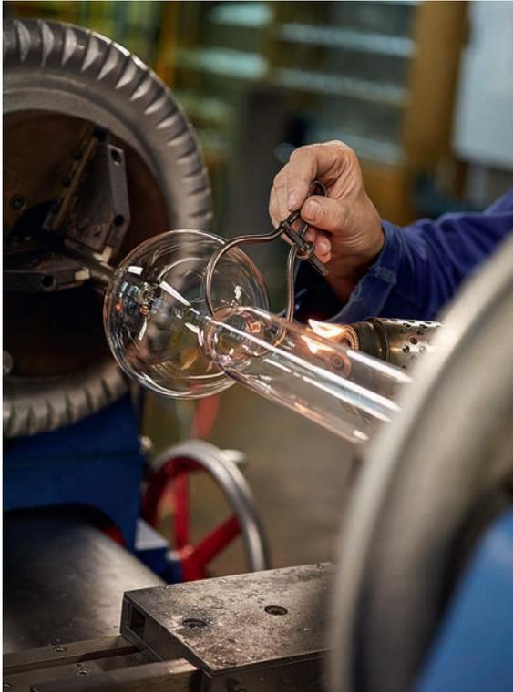
*Feuersbrunst: An der Flamme erfährt ein vorgefertigtes Glasteil sein Finish.*
