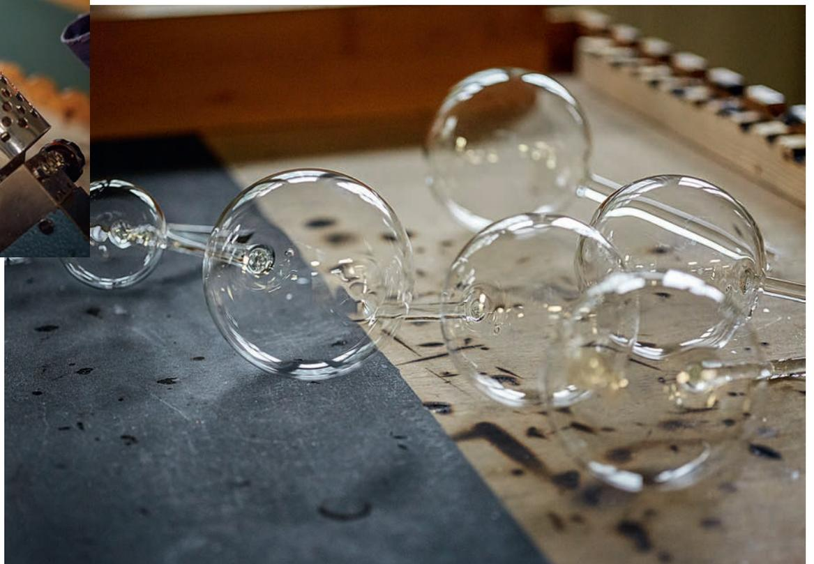
*Glaskugeln: Die einzelnen Borosilikatglas-Elemente von Lüster «Cloud» haben einen Durchmesser von bis zu zehn Zentimetern, sind sehr leicht und stabil.*
