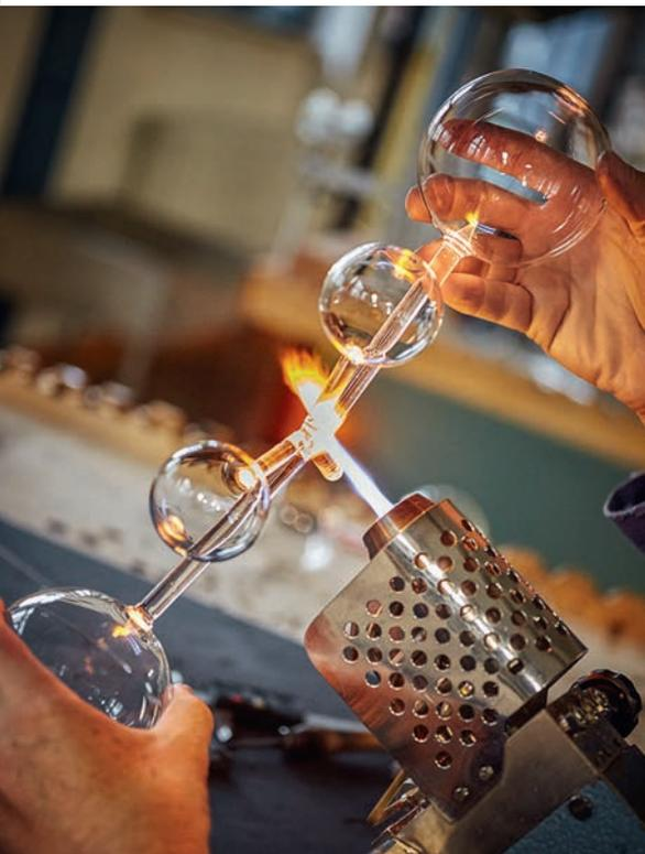
*Präzision: Jede einzelne Kugel wird vom Glasbläser geblasen, dann mit einer gläsernen Stange entsprechend dem Entwurf von Isabel Hamm verbunden.*
