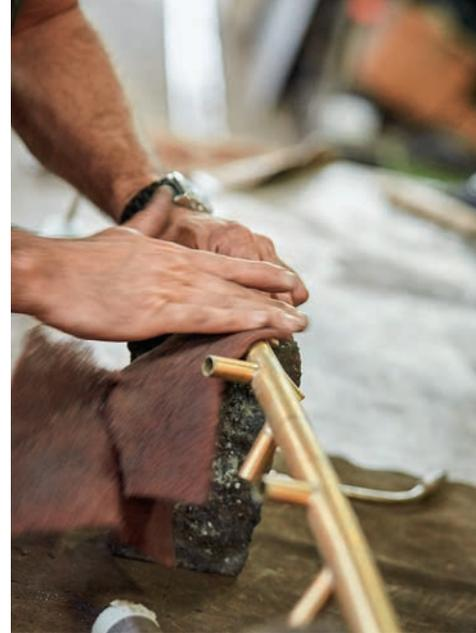
*Fast Goldig: Das Messing wird geschliffen und poliert bis es seinen unvergleichlichen, perfekten Glanz erhält.*
