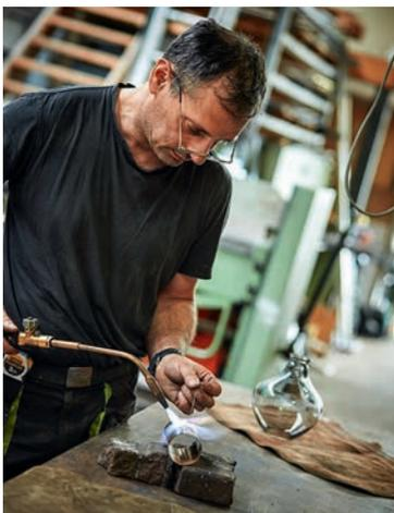
Zusammenfügen: Der Metallbauer lötet den Messing-Zylinder einer Pendelleuchte.
